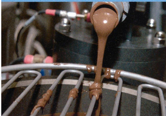
Schokoladenkreation im Labor: Im Vorkristallisator (unten links) lassen sich die Eigenschaften der braunen Masse festlegen, später wird sie zu Tafeln gegossen und bei 18 Grad gelagert (oben).
