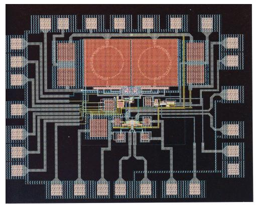
Kein Stickmuster, sondern das Layout des Schaltkreises eines an der ETH Lausanne entwickelten Ultrabreitband-Empfängers für Sensorennetzwerke
