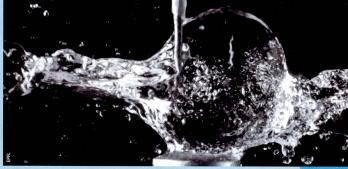
Bei der Kavitation bilden sich durch Druckveränderungen Blasen, die implodieren. Dies verstärkt z.B. die <mark>Erosion</mark> von Wasserturbinen und Schiffspropellern (links). Die Schwarzweissbilder zeigen die Kavitation in der Schwerelosigkeit: Elüssigkeit in Kugelform; darin implodiert eine Blase (ganz oben), und es entstehen zwei Strahlen (oben).
