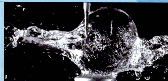
Bei der Kavitation bilden sich durch Druckveränderungen Blasen, die implodieren. Dies verstärkt z.B. die Erosion von Wasserturbinen und Schiffspropellern (links). Die Schwarzweissbilder zeigen die Kavitation in der Schwerelosigkeit: Flüssigkeit in Kugelform; darin implodiert eine Blase (ganz oben), und es entstehen zwei Strahlen (oben).
