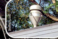
Eine Messstation saugt Luft durch einen Feinstaubfilter. Täglich wird das Gewicht der darauf abgelagerten Feinstaubmenge gemessen.
