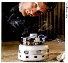
Thomas Lochmatter mit einem Modell eines Roboters, der Gase aufspüren kann.
