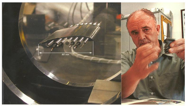
Prof. Albin Bölcs (rechts) testet die Druckverhältnisse eines Modells im Windkanal mit Hilfe der PSP-Methode.
