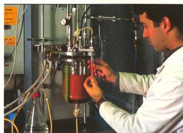
**BAKTERIENZUCHT:** Ausgeklügelte Messtechnik erlaubt genaue Wärmemessungen bei Bakterienkulturen. Sie geben Forschern Aufschluss über den Stoffwechsel und den Energiehaushalt der Kleinlebewesen.
