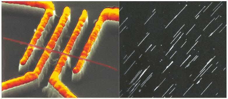
Kohlenstoffröhrchen (rosa) auf vier Goldelektroden. Der Abstand zwischen den Elektroden beträgt 300 Nanometer.
