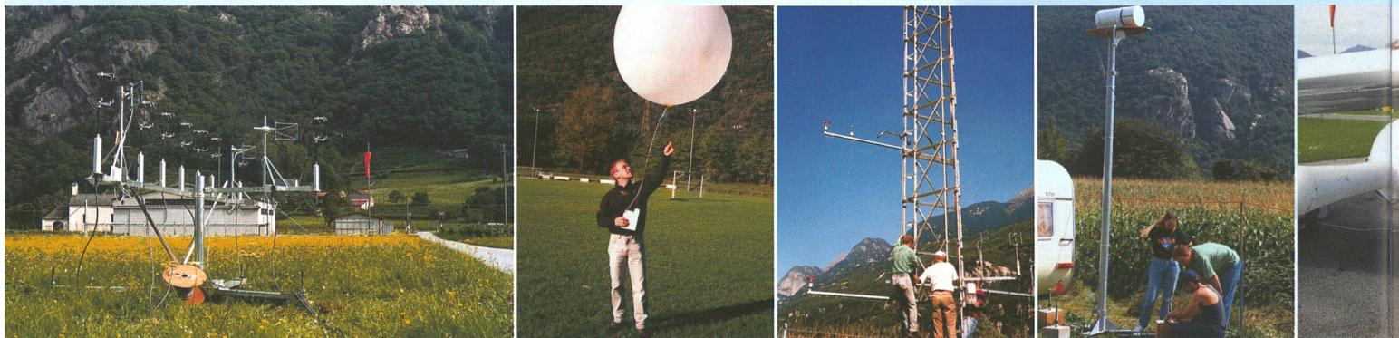
**Enges Zusammenspiel von Modellierung und Messungen:** Bei der ETH-Station Claro im Tessin kamen ein Ultraschall-Windmesser und ein Krypton-Luftfeuchtigkeitsmesser, eine Radiosonde, ein meteorologischer Turm, eine Mikrowellen-Atmosphärensonde und ein auf einem Flugzeug montierter Turbulenzmesser zum Einsatz (v.l.n.r.).
