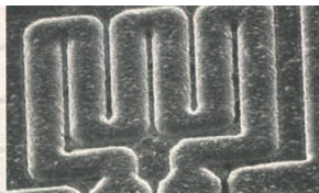
Mit Diamant beschichteter Temperaturfühler in einem Gas-Sensor. (Foto: CSEM)
