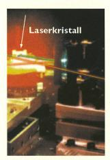
Der Resonator des Weltrekordlasers wurde mit Spezialspiegeln aufgebaut, zwischen denen sich der Laserkristall befindet: ein mit Titanionen dotierter Saphirkristall (rot). (Foto ETH Zürich).
