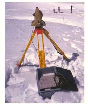
Der Laser-Theodolit vermisst die Position des Georadars.
