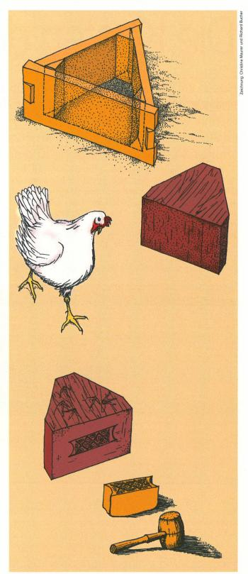
Nachdem er in einem Holzrahmen seine Form erhalten hat, wird der zukünftige Backstein an der frischen Luft getrocknet. Es ist vorgekommen, dass während dieser Phase Tiere ihre Spuren hinterlassen haben. Hat er einmal eine gewisse Konsistenz erreicht, wird der Stein gereinigt und geglättet und dann mit Hilfe der Stempel verziert.
