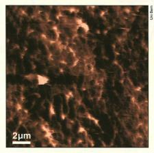
Wie sich zeigte, besteht die Knorpeloberfläche – eine Schicht von 200 bis 500 Nanometern Dicke – aus einem weder zellulären noch faserigen Material: Es handelt sich um eine Art Gelatinefilm (Bild oben). Im Gegensatz zu früheren Beobachtungen mit Elektronenmikroskopen liessen sich nun nur wenige Unregelmässigkeiten feststellen. Die Oberfläche erschien sehr homogen und wies bloss an einigen Stellen Löcher auf, die einen Blick in das
