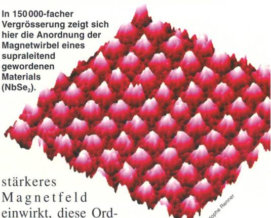
stärkeres Magnetfeld einwirkt, diese Ordnung wieder auf – als ob sich Eiskristalle in Schmelzwasser verwandeln würden. Dies verhinderte bisher die Konstruktion leistungsfähiger Elektromagnete aus supraleitender Keramik.
