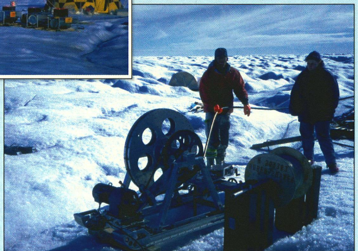
Unten: Präzisionsvorrichtung für das Einregeln des Schlauches, der das Heisswasser in die Tiefe zur Bohrspitze führt.
