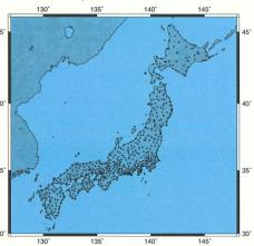
Bodendeformationen zu messen. Die Dauerüberwachung dient der Erdbebenvorhersage und arbeitet mit einer Genauigkeit von fünf Millimetern. Das oft durch schwere Beben erschütterte Japan erhofft sich von den GPS-Daten eine rechtzeitige Warnung bei solchen Naturkatastrophen.
