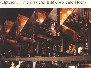
präzisions-Videokamera gleichzeitig bis zu 50 Lichtspuren geladener Teilchen verfolgen kann.
