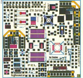
Ein modernes Kunstwerk? Nein, es sind Schaltpläne für verschiedene Modelle von Mikrosensoren, die dann in der Fabrik auf Silizium übertragen werden.
