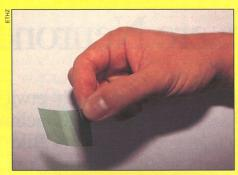
Der Spezialfilm besteht aus Polyvinylbutyral. Darin eingelagert sind Chlorin-Moleküle (2,3-Dihydroporphyrin), die ihm eine grüne Farbe geben.
