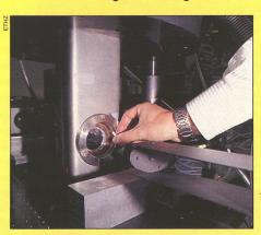
Im Kern dieses Zylinders sitzt der Film. Ein Kühlsystem mit flüssigem Helium hält seine Temperatur auf -271 Grad Celsius. Das vom Teleskop eingefangene Sonnenlicht fällt durchs Bullauge auf den Film.
