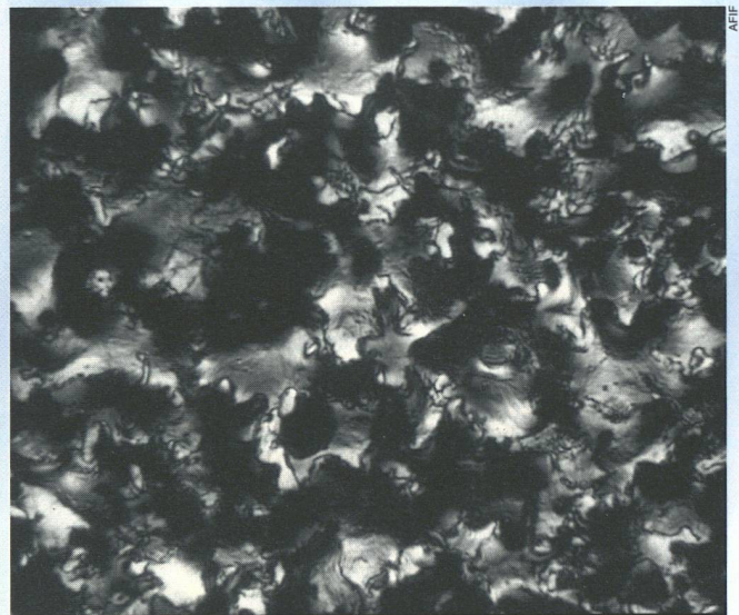
Ultraschall macht die bei der Funkenerosion entstandenen Unregelmässigkeiten wenige Mikron unter der Stahloberfläche sichtbar (Vergrößerung 425x).
