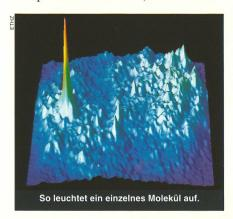
gehört zu den Kohlenwasserstoffen) bei -271 °C, nur zwei Grad über dem absoluten Nullpunkt, unter einem Mikroskop plaziert. Die Kälte bringt den Tropfen zum Erstarren und macht ihn durchsichtig; er gleicht nun einem Salzkorn. Verteilt im Hexadekan befinden sich einzelne Moleküle von Terrylen wie Rosinen in einem Kuchen.
