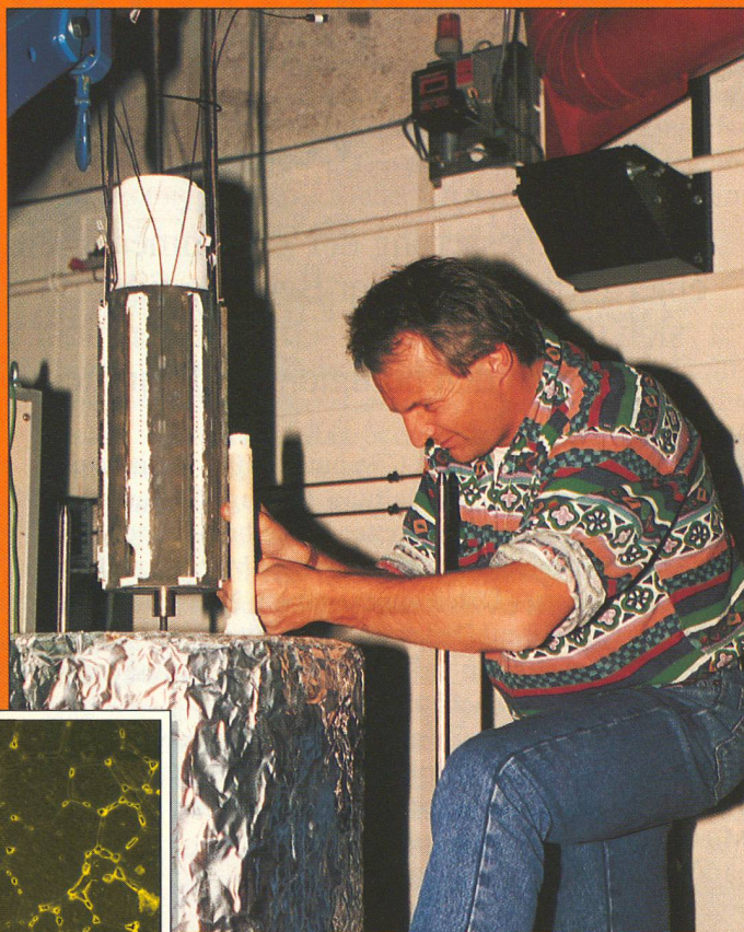
Oben: 50 Scheiben bauen diesen Prototyp einer Brennstoffzelle von 1000 Watt Leistung auf.
