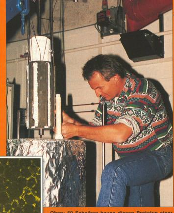
Oben: 50 Scheiben bauen diesen Prototyp einer Brennstoffzelle von 1000 Watt Leistung auf. Links: Oberfläche einer Scheibe, 500fach vergrössert.
