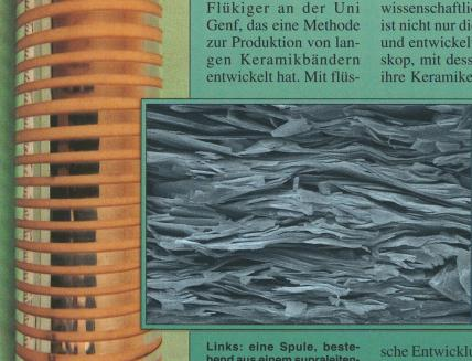
Links: eine Spule, bestehend aus einem supraleitenden Keramikband (Bi 2223) in einer Silberhülle.
