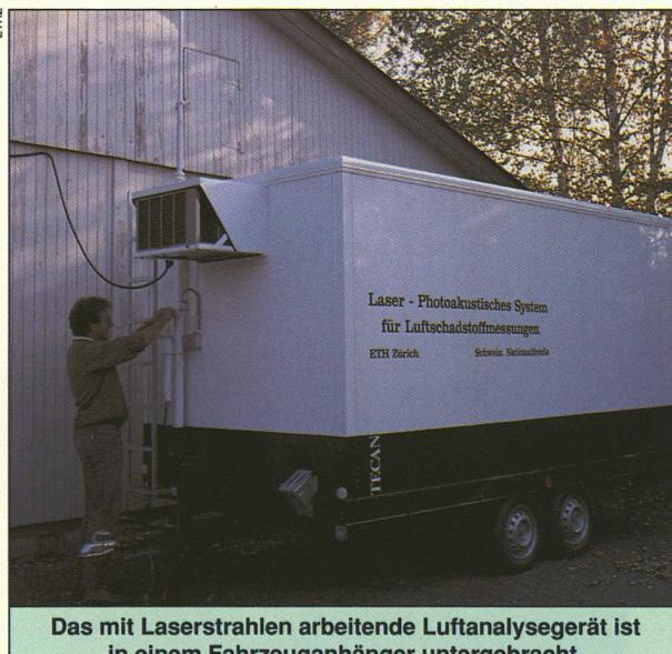
Das mit Laserstrahlen arbeitende Luftanalysegerät ist in einem Fahrzeuganhänger untergebracht.
