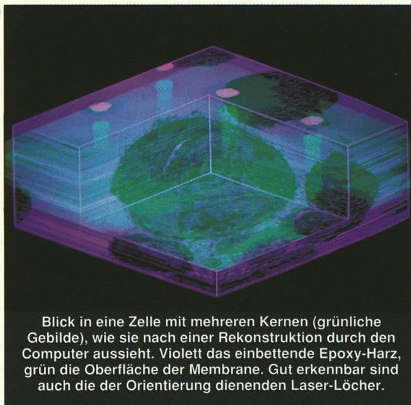
andere auseinandergezogen. Mit Computer-Unterstützung lassen sich solche Verzerrungen rechnerisch rückgängig machen. Indem sich der Rechner mit seiner Hauptspeicherkapazität von 64 Mb an die Laser-Löcher hält, kann er die nötigen Korrekturen anbringen. Das Programm für derart spezialisierte Operationen wurde in Frankreich entwickelt: am Lyoner Institut für industrielle Chemie und Physik von Prof. Michel Jourlin.
