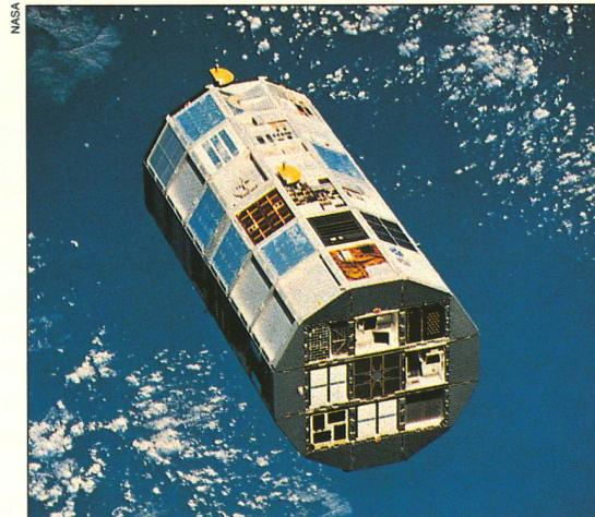
Während sechs Jahren sind solche Atome auf die sieben Kupferfolien aussen am Satelliten geprallt. Um die Atome jetzt noch zu erkennen, müssen die Platten in einer Vakuumkammer auf 1200°C erhitzt werden. In dem Masse wie die Temperatur steigt, kommen immer tiefer im Kupfer sitzende Atome frei. Sie werden anschliessend elektrisch geladen, beschleunigt und einem Magnetfeld in einem Massenspektrometer ausgesetzt, das die verschiedenen Formen von Helium und Neon in der Erdumgebung identifiziert.
