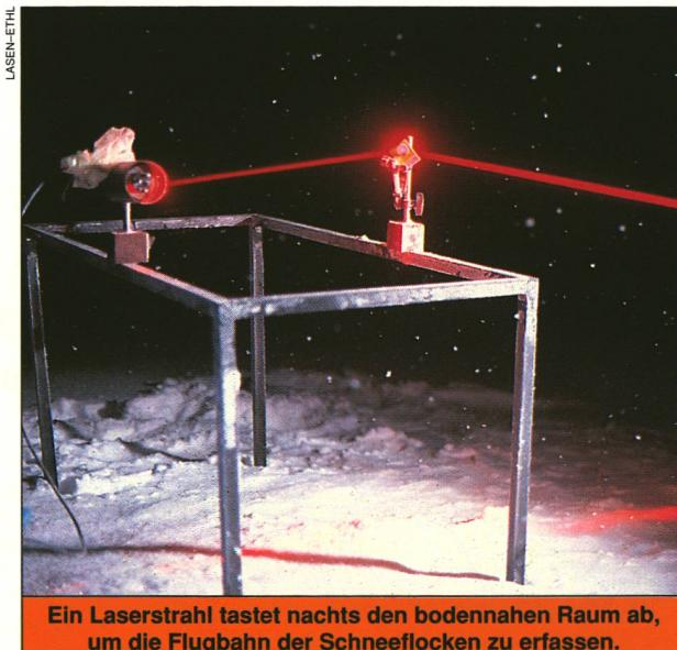
Ein Laserstrahl tastet nachts den bodennahen Raum ab, um die Flugbahn der Schneeflocken zu erfassen.
