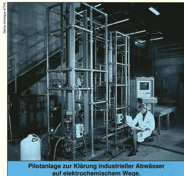
elektrochemische Methode die Schadstoffe besser aufschliesst, als Ozon oder Wasserstoffsuperoxid es können. Ausserdem wiesen die Elektroden so gut wie keinerlei Verschleissspuren auf.
