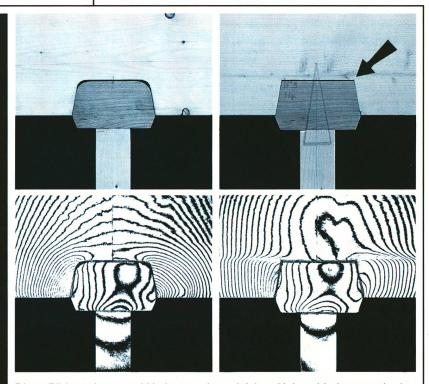
Diese Bilder zeigen zwei Varianten einer gleichen Holzverbindung sowie das entsprechende *Moiré*-Bild. Beim Holzverband auf dem linken Photo verteilt sich der Druck harmonisch auf den ganzen Querbalken, während rechts die scharfen Kanten des Mittelstücks (Pfeile) Spannungen erzeugen, die zum Bruch des Holzes führen können. (Bilder: IBOIS-ETHL)
