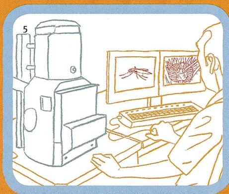
**III. 1** Pour pouvoir passer sous le microscope électronique à balayage (MEB), l'échantillon doit d'abord être résistant au vide. Et il doit être préparé. Et s'il n'est pas conducteur, comme notre mouche en page 7, on commence par le recouvrir d'une couche extrêmement fine de métal grâce à un pulvérisateur (P).
