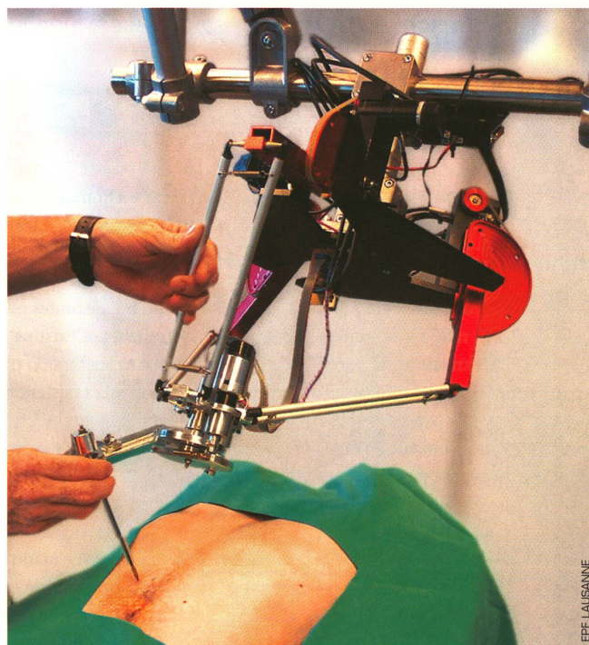
Le dispositif à retour de force DELTA donne la sensation du toucher pendant de petites interventions par endoscopie.
