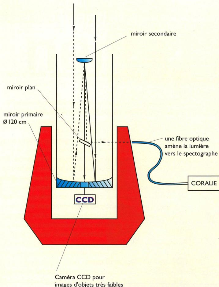
Découpage du télescope de 1,2 m: la lumière qui parvient au miroir primaire est réfléchi sur le miroir secondaire qui la dirige sur la caméra CCD ou, en utilisant un miroir plan au centre du télescope, sur le spectrographe CORALIE.
