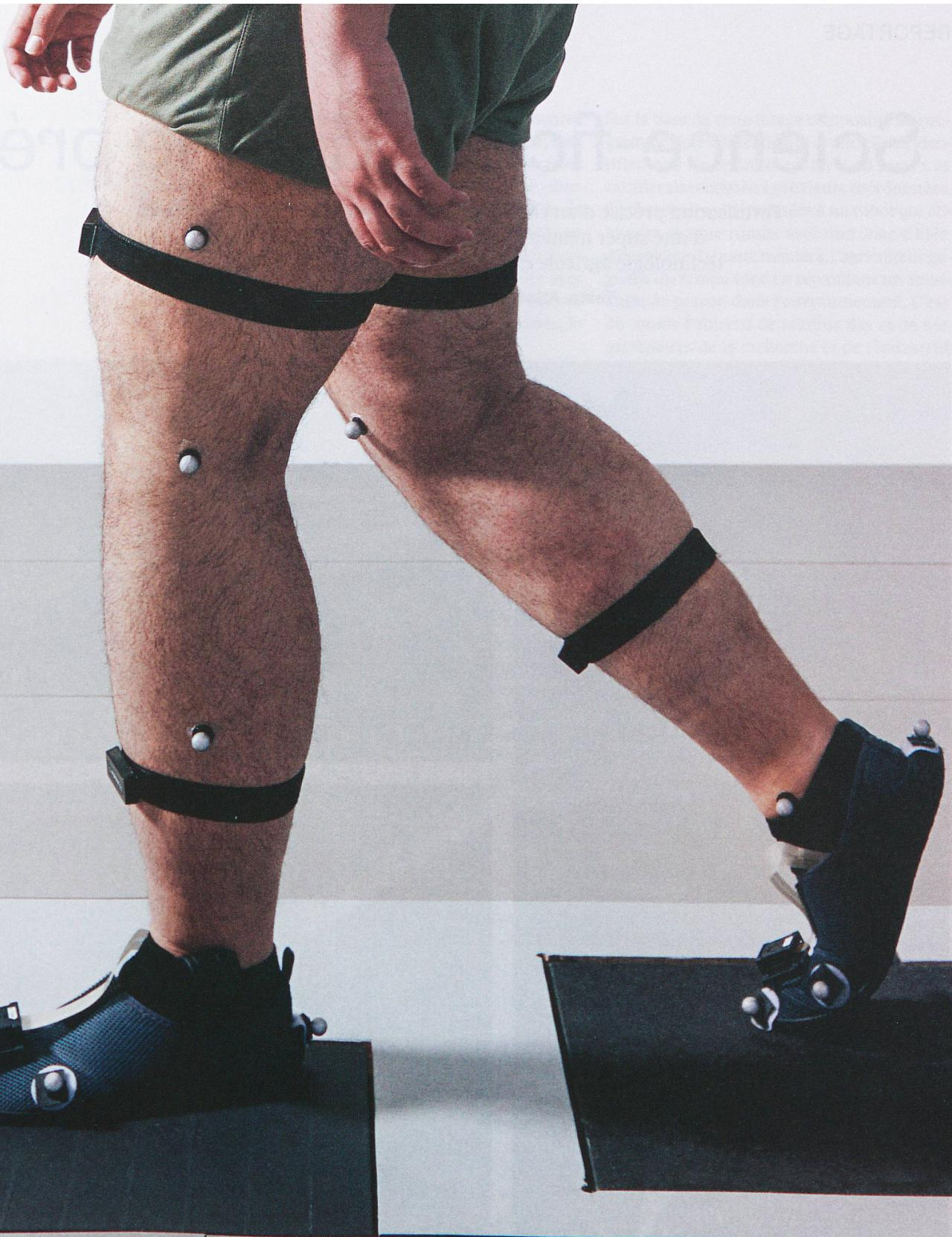
Les capteurs sur les jambes permettent aux chercheurs du Laboratoire d'analyse et de mesure du mouvement de l'EPFL de déterminer la charge sur l'articulation du genou. Photo: Gian Paul Lozza
