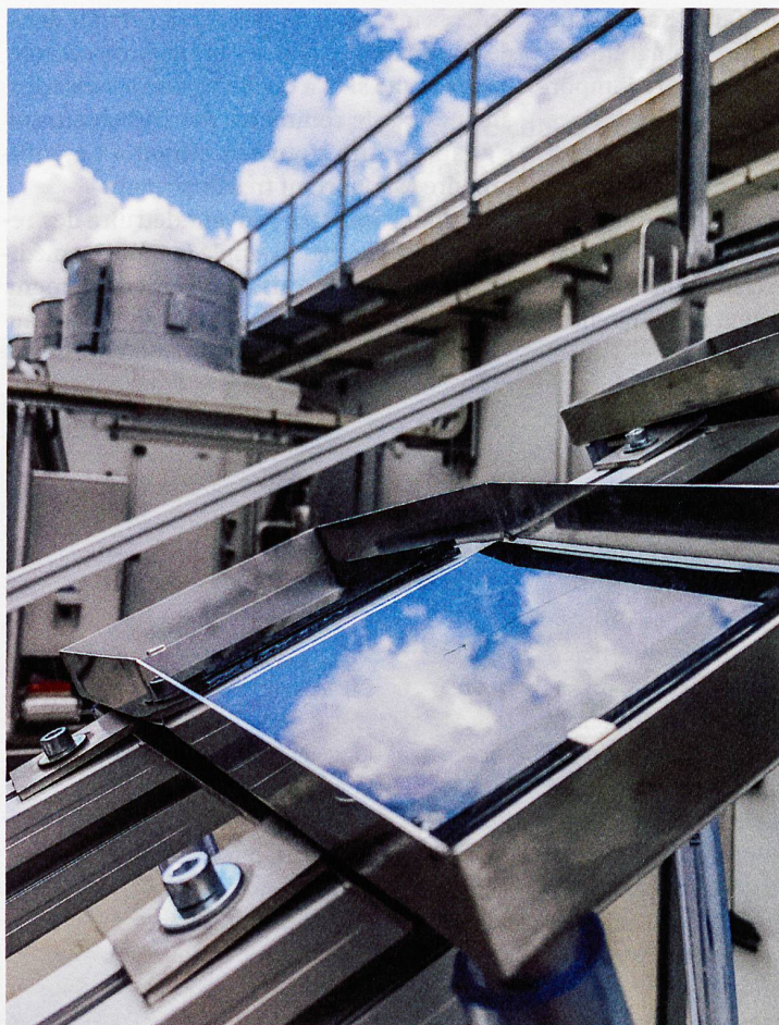
Sur le toit à Muttentz, on teste si du plomb issu des cellules photovoltaïques en pérovskite peut finir dans les eaux pluviales. Photo: mäd
