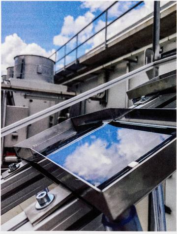
Sur le toit à Muttenz, on teste si du plomb issu des cellules photovolta $\ddot{a}$ ques en pérovskite peut finir dans les eaux pluviales. Photo: màd
