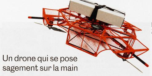
Les drones de fret ont besoin d'aires d'atterrissage spéciales parce que leurs rotors représentent un danger au décollage et à l'atterrissage. Le **chercheur en robotique Przemyslaw Kornatowski de l'EPFL** vient de mettre au point un drone qui, à basse altitude, **rétracte ses hélices dans une cage rigide**.
