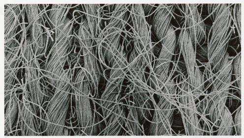
Fibres de polyester dans un tissu interlock sous le microscope électronique. Photo: Y. Cai et al (2020)
