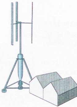
Au lieu de l'axe horizontal usuel, Agile Wind Power développe des éoliennes avec un rotor à axe vertical. Selon l'entreprise, elles auraient l'avantage d'être nettement moins bruyantes et d'épargner oiseaux et chauves-souris. Ainsi, ces éoliennes verticales pourraient être un produit de niche de production décentralisée d'électricité, par exemple à proximité de zones d'habitation.
