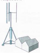
Au lieu de l'axe horizontal usuel, Agile Wind Power développe des éoliennes avec un rotor à axe vertical. Selon l'entreprise, elles auraient l'avantage d'être nettement moins bruyantes et d'épargner oiseaux et chauves-souris. Ainsi, ces éoliennes verticales pourraient être un produit de niche de production décentralisée d'électricité, par exemple à proximité de zones d'habitation.
