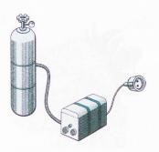
Les piles à combustible produisent de l'électricité par réaction électrochimique entre le combustible et un oxydant. Près de Lausanne, la start-up EH Group Engineering développe des piles particulièrement compactes pour l'utilisation d'hydrogène. Lorsque celui-ci est produit avec du courant issu d'énergies renouvelables, l'emploi de ce type de piles est très respectueux du climat.
