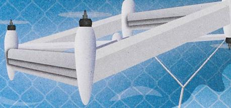
**Skypull** raffole des vents forts à 400 mètres d'altitude. Attaché par un câble à un générateur électrique placé au sol, il lui transfère l'énergie éolienne. Origine: ETH Zurich. Autre producteur de courant: Twingtec, originaire de l'EMPA, la FHNW et l'ETH Zurich.
