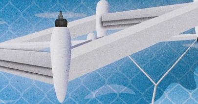
**Skypull** raffole des vents forts à 400 mètres d'altitude. Attaché par un câble à un générateur électrique placé au sol, il lui transfère l'énergie éolienne. Origine: ETH Zurich. Autre producteur de courant: Twingtec, originaire de l'EMPA, la FHNW et l'ETH Zurich.
