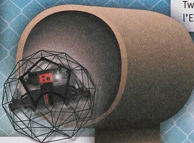
**Verity** se déplace en essaim. Célèbre pour ses spectacles lumineux, il navigue également avec aisance à l'intérieur grâce à sa géolocalisation basée sur l'ultra wideband. De petite taille, léger et inoffensif. Origine: ETH Zurich.
