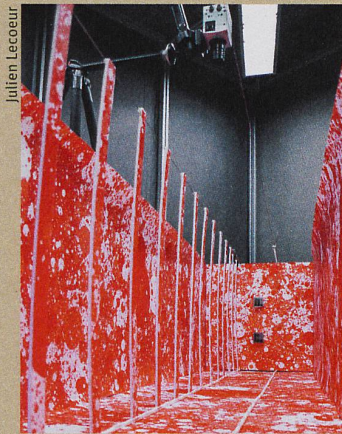
Des caméras suivent le vol d'insectes dans un corridor aux parois bariolées.
