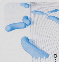
Les nano-piliers d'une surface antibactérienne déchirent la membrane des microbes.
