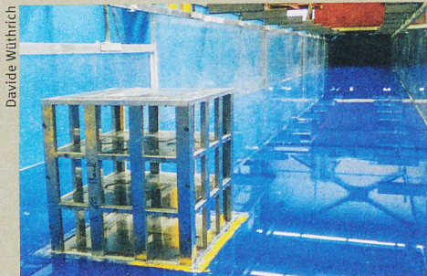
Est-ce que le bâtiment – modélisé par un cube percé d'ouvertures – résistera à la vague?
