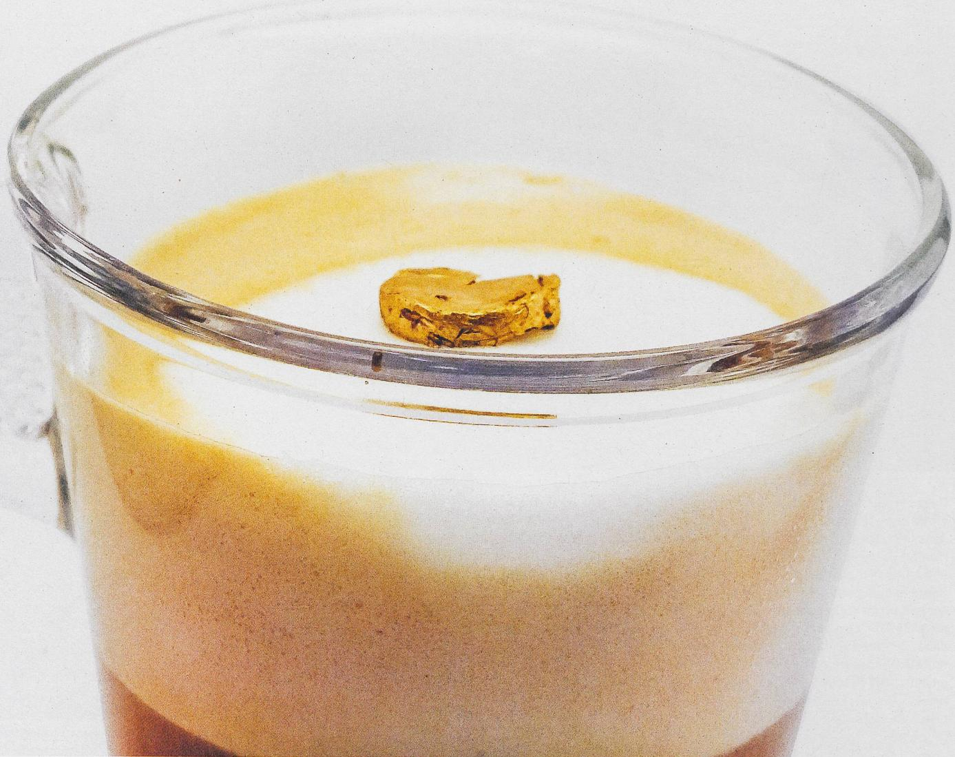
Une sorte d'éponge faite d'or et de protéines: cet aérogel flottant délicatement à la surface d'un cappuccino pourrait un jour servir de catalyseur pour des réactions chimiques. Image: Nyström/Mezzenga
