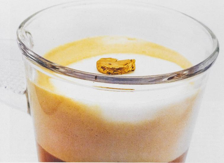
Une sorte d'éponge faite d'or et de protéines: cet aérogel flottant délicatement à la surface d'un cappucino pourrait un jour servir de catalyseur pour des réactions chimiques. Image: Nyström/Mezzenga
