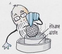
...qu'il congèle instantanément dans de l'éthane à -196°C et maintient au frais dans un bain d'azote liquide.
