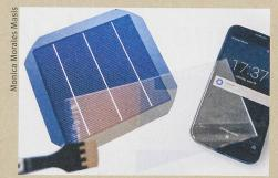
Des scientifiques ont pu fabriquer des électrodes transparentes (au premier plan) avec du zinc.
