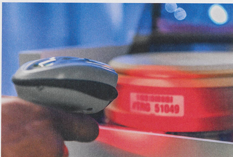
A l'Hôpital de l'île à Berne, des échantillons biologiques de patients sont scannés avant d'être rangés automatiquement dans une cuve frigorifique à -150 °C. Photo: Insel Gruppe/Pascal Gugler
