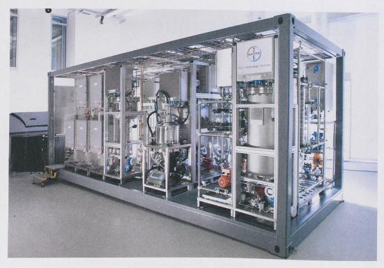
La vision du projet européen F3: une mini-usine chimique standardisée et transportable par container.
