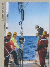
Embarqué sur le navire de recherche G.O. Sars, ce tube prélève des échantillons du fonds marin.
