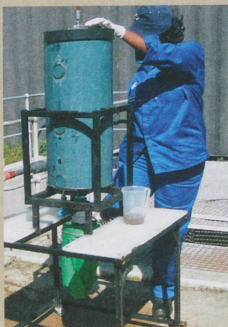
Ce réacteur transforme l'urine en struvite, un fertilisant solide moins problématique.
