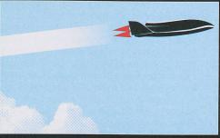
2 Le véhicule suisse baptisé Soar mesure quelque 15 mètres sur 10. Il atteindra une vitesse de 7 600 km/h et l'altitude de 80 kilomètres, une zone où les effets de l'atmosphère deviennent négligeables. Il sera propulsé par une version modifiée du moteur de fusée russe NK-39, de la famille de celui qui équipe le troisième étage du lanceur Soyouz. Le groupe français Dassault Aviation fournira notamment le poste de pilotage au sol, basé sur celui de son drone de combat furtif Neuron.
