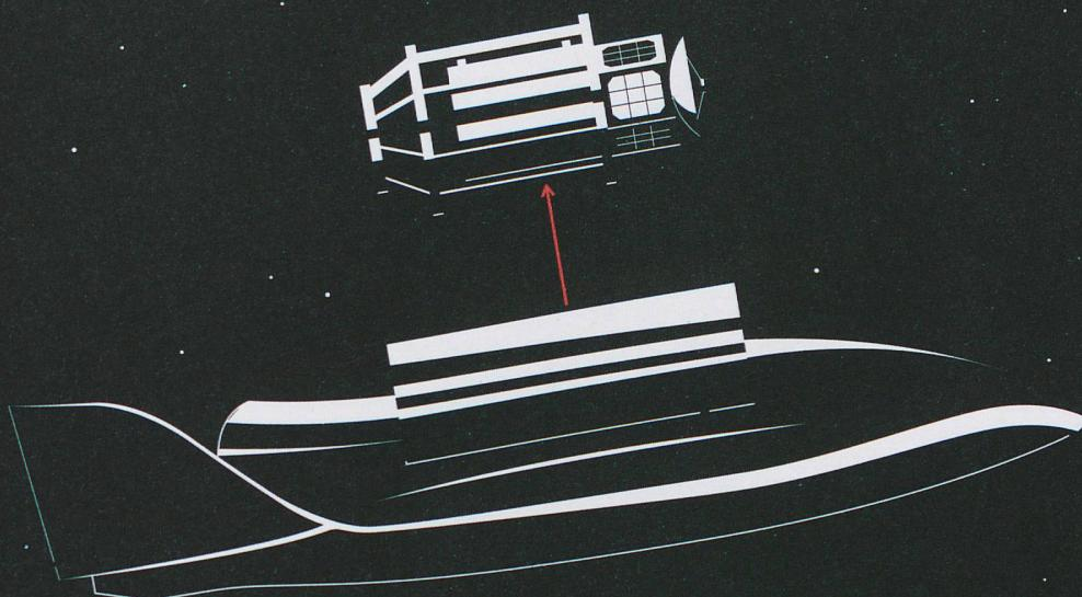
**3** Soar libérera un troisième étage pour emmener les satellites en orbite terrestre basse, jusqu'à une altitude de 700 kilomètres. Cet élément du système S3 brûlera lors de sa rentrée dans l'atmosphère afin d'éviter de
