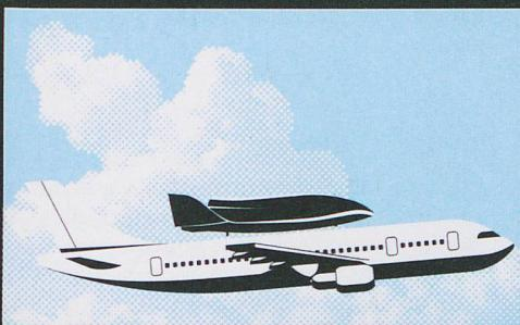
**1** Swiss Space Systems (S3) développe une navette pour la mise en orbite de petits satellites. Contrôlée depuis le sol, le véhicule se détachera du dos d'un Airbus volant à une altitude de 10 000 mètres. Les premiers vols commerciaux sont prévus pour 2018. La société, fondée en 2012 à Payerne (VD), intègrera dans sa navette les technologies d'une vingtaine de partenaires internationaux. Elle envisage d'entrer en Bourse d'ici fin 2015.
